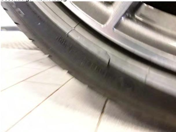
Beschädigung #3: Rad/Reifen: Reifen hinten rechts (Seitenwan...
