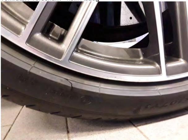
Beschädigung #4: Rad/Reifen: Leichtmetallfelge hinten rechts - verkratzt / verschürft - kein Abzug
