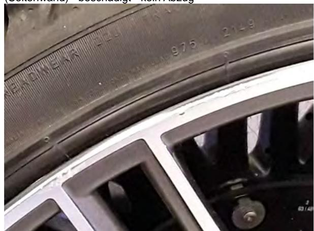
Beschädigung #4: Rad/Reifen: Leichtmetallfelge hinten rechts
